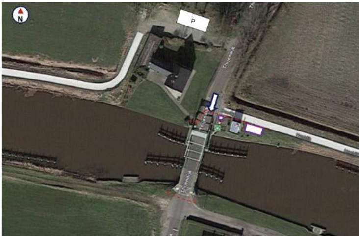
Figuur 3-1. Bouwplaatsinrichting Thijendijksbrug
